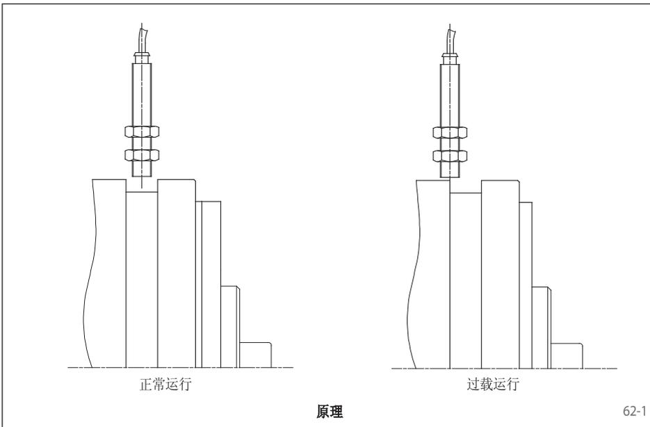
过载发生时可利用扭矩限制器SIKUMAT®的轴向移动来触发接近开关，因此当超过预设扭矩时，驱动可被关掉，同时/或触发电信号。
